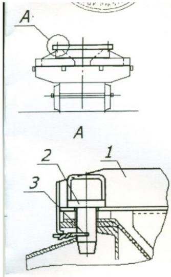
Упорные балки (поз.1) размещают на рамах в средней части платформы тем же порядком, что и при закреплении рулонов и фиксируют на верхней плоскости рамы штатными фиксаторами (поз. 2), устанавливаемыми в отверстия балки и рамы. Фиксаторы упорных балок должны быть зашплинтованы проволокой диаметром не менее 4 мм с закруткой концов проволоки в три оборота.
